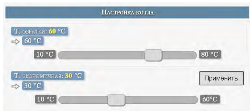
Рис.8.5. Вкладка настройки котла.
