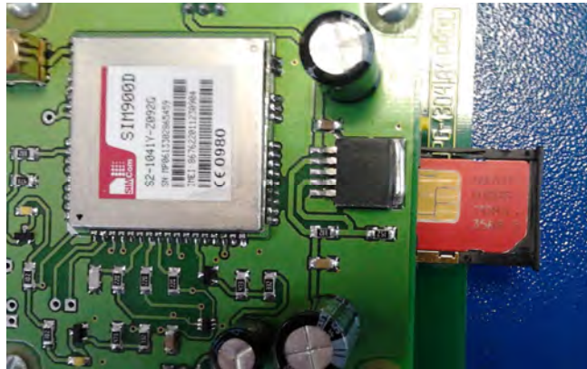
Фото 15.1. Установка лотка на место
